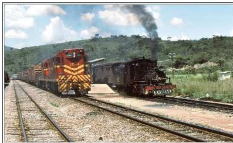
Posto PBA, limites do município de Bom Sucesso, MG, 1979. Na imagem, paralelos, trem da bitola de 1,00m tracionado por locomotiva diesel-elétrica (EMD G8/12) e trem da "bitolinha" comandado pela "vaporosa" RFFSA SR-2 62 ( Consolidation ). Foto de Herbert Graf.
